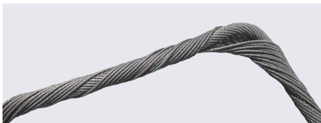
Heraustreten der Stahlseileinlage bei drehungsfreien Seilen
