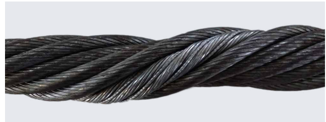
Heraustretende Einlage, einlagiges Seil
