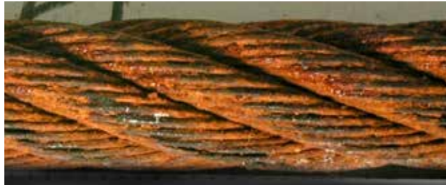
4. Superficie muy picada y cables bastante flojos, espacios entre cables - Deseche inmediatamente
