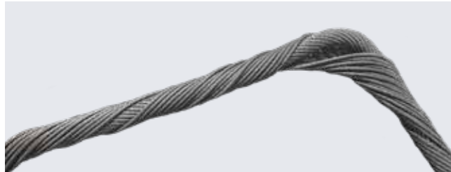
IRWC protuberado en cables antigiratorios
