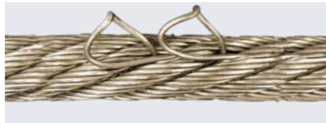
Cables sobresalientes del alma
