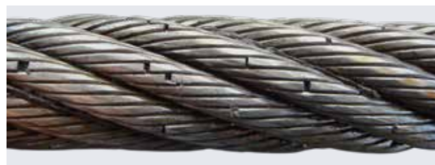
Alambres rotos de corona
