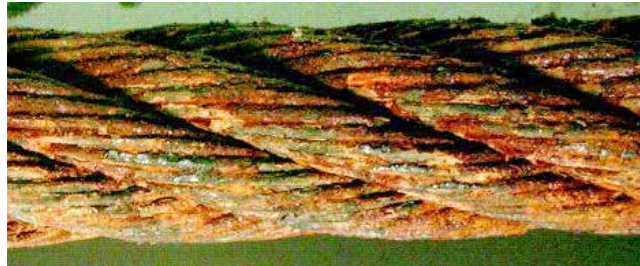
3. Superficie muy afectada por la oxidación - Clasificación: 60% hacia el descarte
