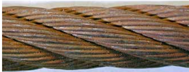
1. Comienzo de la oxidación de la superficie, puede limpiarse, superficial - Clasificación: 0% hacia el descarte
